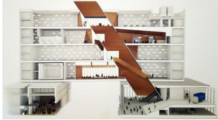
صورة (59) قطاع رأسى طولى يوضح محاكاة المضمون الوظيفى للفناء الاسلامى والمصمّم على محور مائل من اعلى الى اسفل لتحقيق الاضاءة والتهوية الطبيعية [7]
